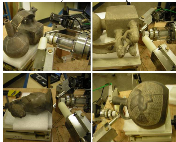
Figura 2 – Imagens das medidas feitas com o arranjo de feixe externo para medidas de cerâmicas Chimu do MAE/USP
