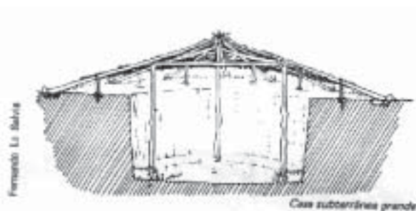
Gravura 2: Desenho esquemático de casa subterrânea
