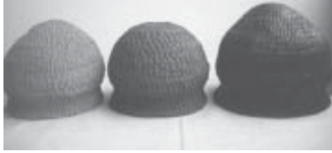
Foto 1: Da esquerda para a direita temos as peças, antes da queima, executadas com as amostras de: 1º Argila de papelaria em Chapecó – SC – P.Cco, 2º de Trindade do Sul – RS – P.EN4, 3º da Cerâmica Chapecó – Pcco3.
