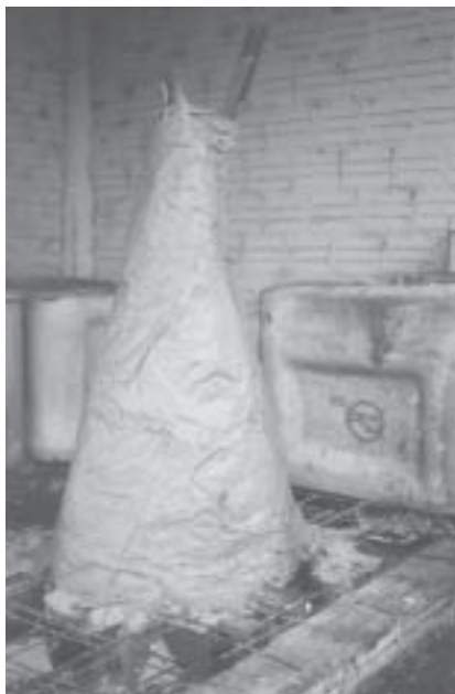
Foto 10: Forno revestido de papel e barbotina
