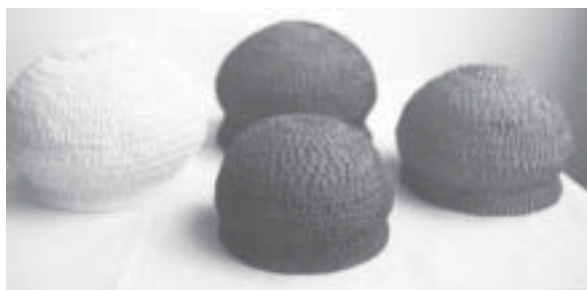
Foto 9: Resultados da queima em forno elétrico. À esquerda, a amostra de São Paulo, À direita, a amostra de argila encontrada em papelarias de Chapecó. À frente, a amostra de Trindade do Sul (RS). Ao fundo, a amostra da Ind. Cerâmica Primavera, de São Carlos (SC).
