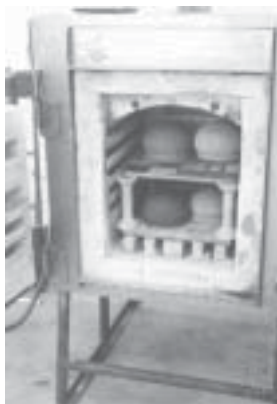
Foto 8: Câmara do forno elétrico aberta após a queima
