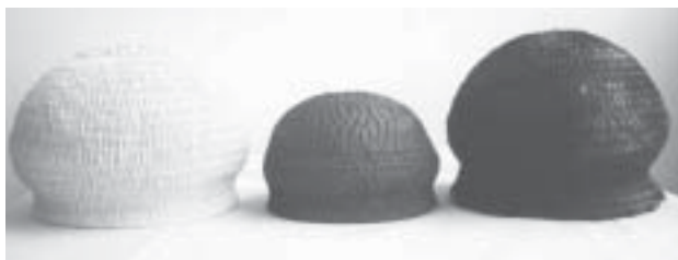
Foto 4: À esquerda, a amostra de São Paulo, queima em forno elétrico, com mudança de cor e contração de 4%. No centro, a amostra de Trindade do Sul, mudança de cor e contração de 24%, além de inúmeras rachaduras. À direita, a amostra de Palhoça, mudança de cor, contração 10%, pequena separação entre dois roletes da borda.
