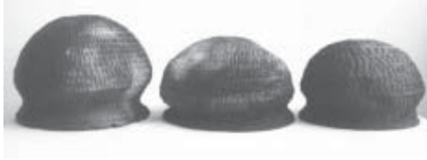
Foto 11: Resultados da queima em forno a lenha: à esquerda, a amostra de Terra Fraca - Município de Palhoça (SC); ao centro, a amostra da Ind. Cerâmica Chapecó; e à direita, a segunda amostra de Trindade do Sul (RS)
