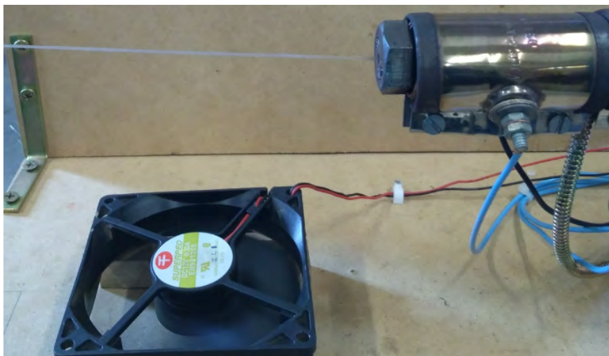
Figura 7: Filamento na saída da extrusora em regime de trabalho alcançado.
