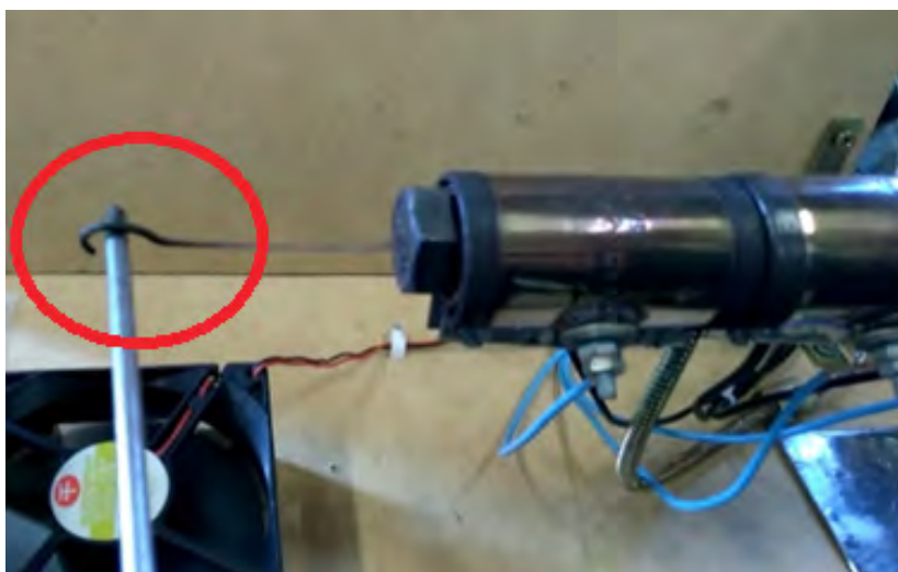
Figura 5: Filamento degradado por tempo de residência no barril.
