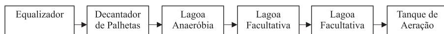
Figura 1 – Fluxograma do sistema de tratamento por lagoas em série do qual resulta o efluente utilizado no Tanque de Aeração.
