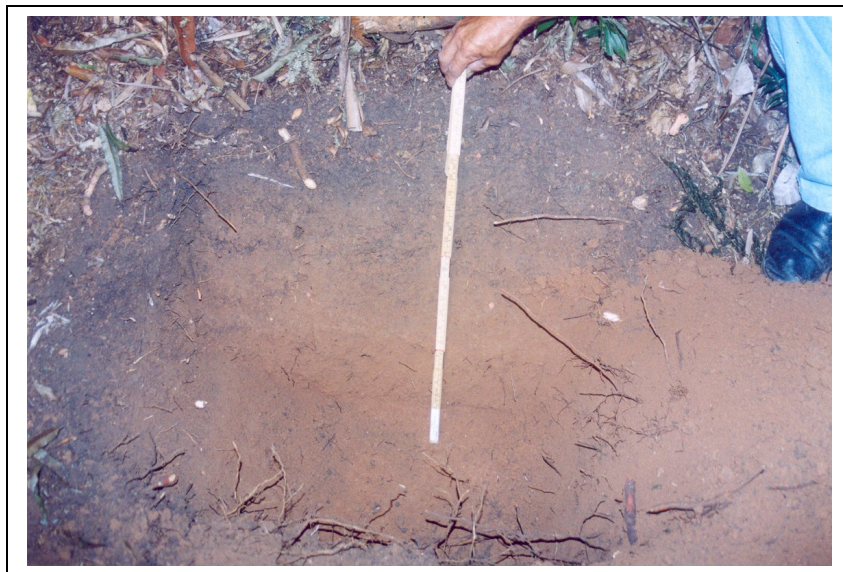
Medindo perfil estratigráfico do ponto T1D, Bota-fora "C".
