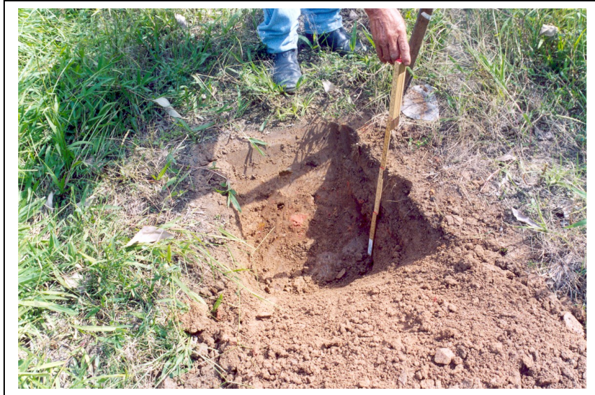
Teste de enxada 1A, sendo medido a profundidade, no Bota-fora "18".
