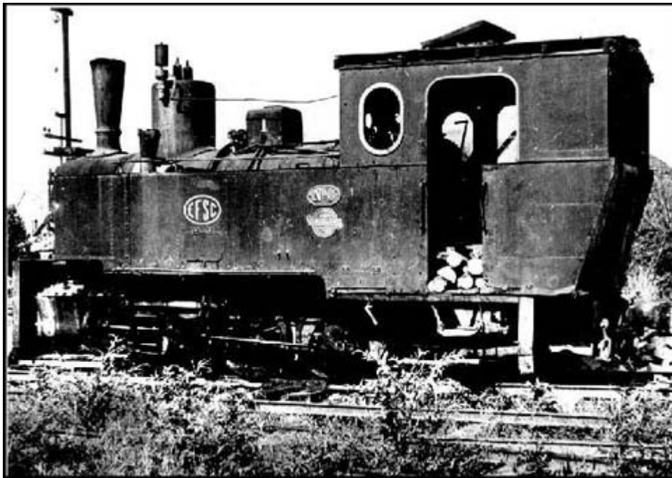
Locomotiva tipo 0-6-0T, fabricada em 1908 pela Orenstein & Koppel, apelidada de macuca pela semelhança de sua silhueta com aquela ave. Foi a terceira adquirida pela EFSC e a única que restou, exposta em frente da Prefeitura Municipal de Blumenau ( www.softhouse.com.br/efsc/historia.htm ).
