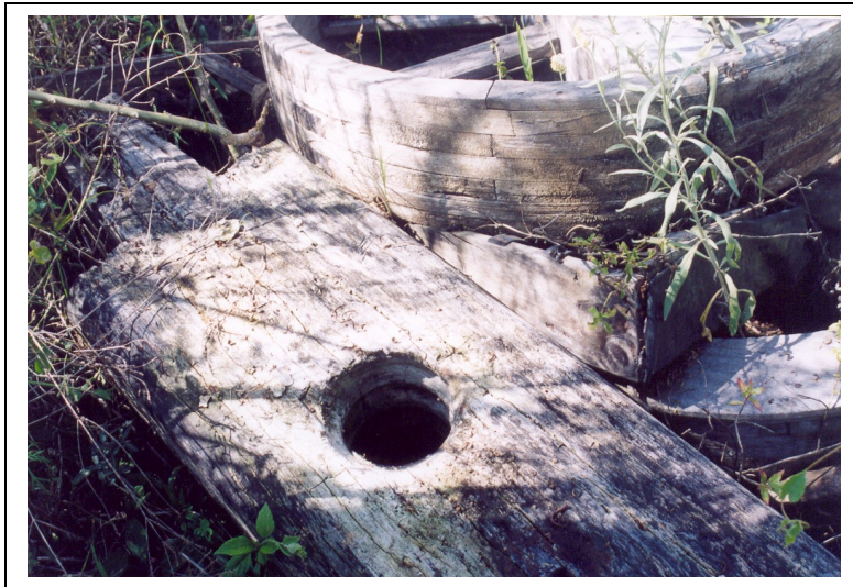
Ficha da prensa, onde o fuso é enroscado.
